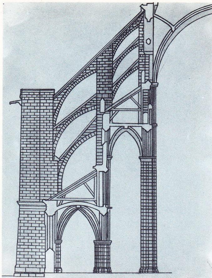
*Schéma de l'extérieur d'une église gothique. Les arcs-boutants rejoignent les murs de la nef centrale à l'endroit où prennent leur appui les nervures intérieures de la voûte, qui est ogivale, soutenue par des arcs brisés (renforcés en leurs points de contact par une clef de voûte) et reliée par des arcs transversaux aux nefs latérales disposées selon l'axe de l'église. L'architecture gothique a été définie dynamiquement par opposition à l'architecture romane, qui est statique.*
